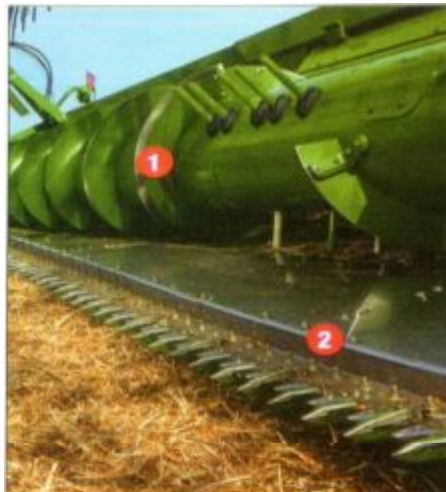
Рис. 3. Шнек жатки John Deere 625F з гнучким різальним апаратом: 1 - шнек жатки; 2 – гнучкий різальний апарат
