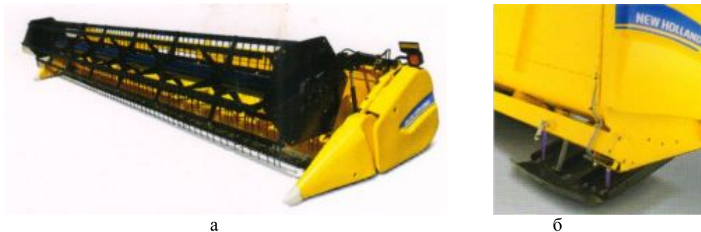
Рис. 1. Жатка Super Flex (а) і автоматичне регулювання висоти жатки (б)
