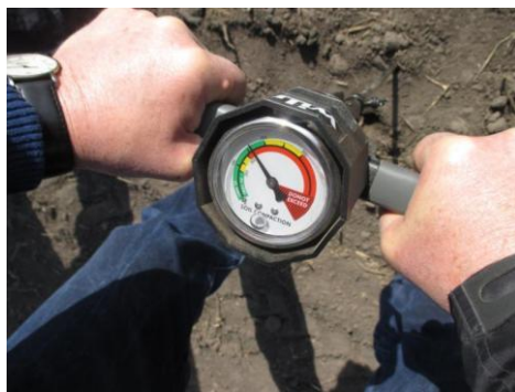
Рис. 1. Пенетрометр фірми DICKEJ-john під час penetрації ґрунту
