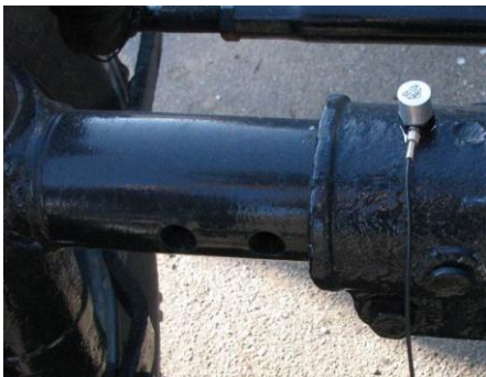
Рис. 2. Установка акселерометра на балці моста трактора МТЗ-80
