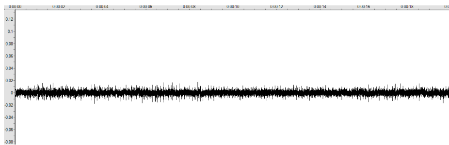
Рис. 5. Осцилограма віброприскорення керованого моста трактора МТЗ-80 при установці акселерометра на висувній трубі моста
