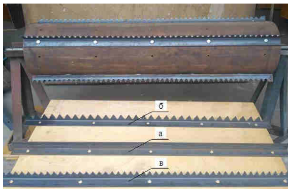
Рис. 1. Проміжний молотильний барабан та варіанти додаткових планок барабана: а – гладкої; б – із зубоподібними профілями з висотою 30 мм; в – із зубоподібними профілями з висотою 20 мм
