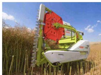
Рис. 8. Жатка VARIO: а - схема роботи жатки VARIO; б – вертикальний інтегрований ніж
